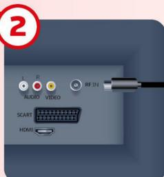
Подключите антенный кабель к антенному входу цифрового телевизора.
